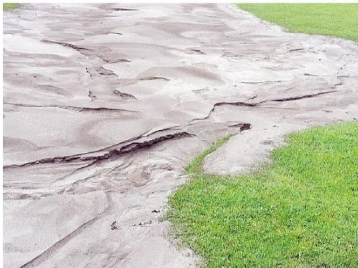
Così si presenta dopo il sisma il terreno dello stadio di S. Felice: terra e sabbia sono salite sopra il manto erboso
